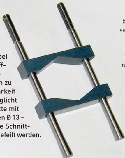
Beim Abtrennen von Bogensegmenten oder ganzen Ringen finden die Prismenbacken sinnvollen Einsatz. Aus Kunststoff gefertigt, bieten sie der zuvor hergestellten Drahtwicklung hervorragenden Halt ohne sie zu beschädigen.
